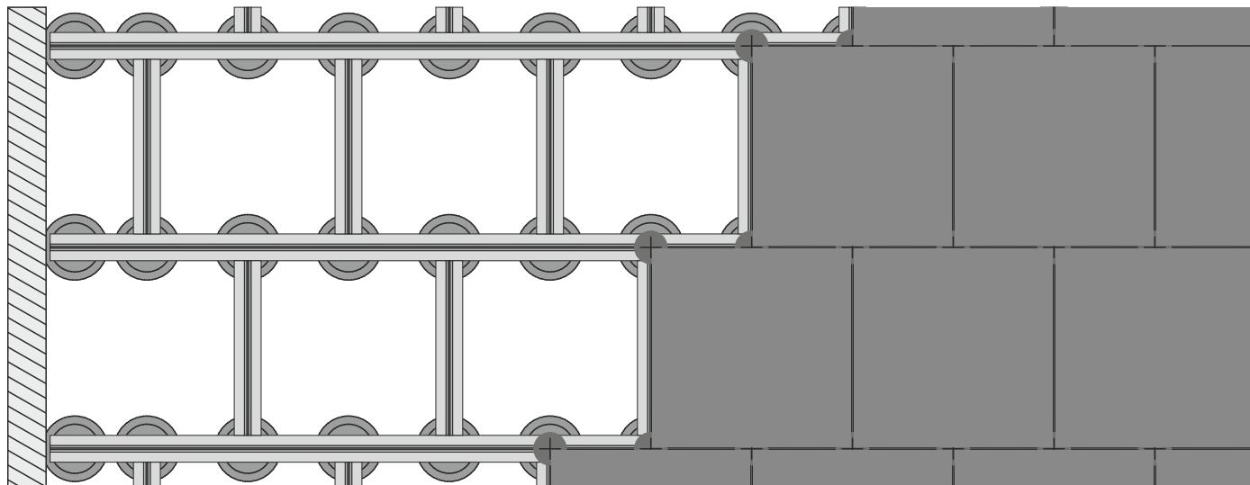
Алюминиевые лаги KRONEKX являются более долговечной заменой довольно быстро приходящим в негодность и коррозионным каркасам из чёрного металла (труб профильных), использование алюминиевых лаг исключает появление на поверхности настила пятен от коррозии подсистемы.
