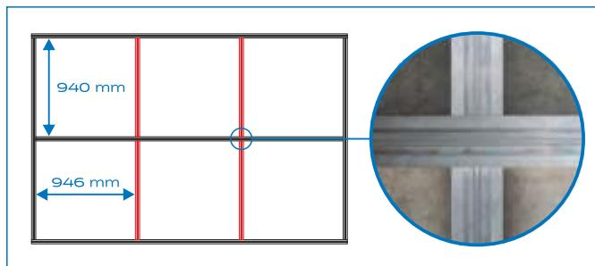
**4** Установить распорки из лаги 80x40x3000мм длиной 940 мм и с таким шагом, как показано на рисунке, используя угловые соединители и саморезы.
