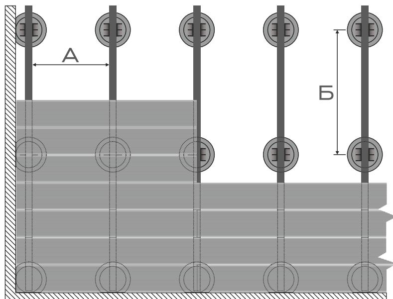
Б - расстояние между опорами вдоль линии укладки лаг не должно превышать 750 мм при использовании несущей лаги 50x25x3000 мм (арт. ALM-0015) и не более 1500 мм при укладке на конструктивные лаги KRONEKX 80x40x3000 мм (арт. ALM-0014). см. стр. 25 >>
