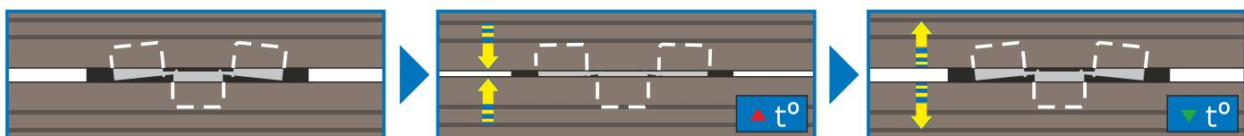
Изогнутая форма кляймера позволяет в момент расширения при нагревании доски сохранить продольный зазор минимум в 2 мм (для вентиляции настила).
