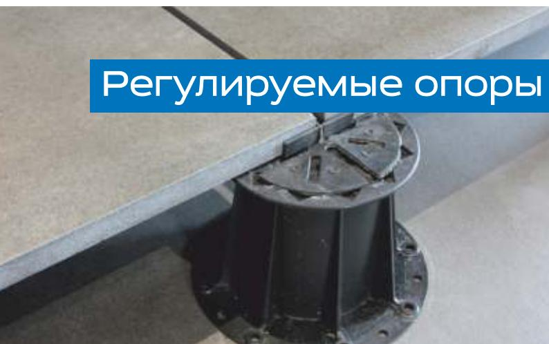
Позволяют поднять уровень настила на нужную высоту, скрыть под фальш-пол инженерные коммуникации и осуществить быстрый монтаж настила без нарушения гидроизоляции основания, в том числе на неподготовленное и неровное основание.
