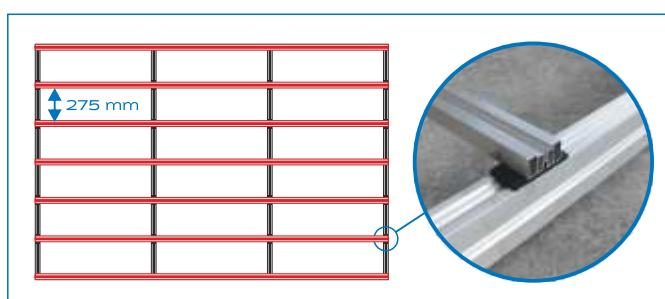
**6** Уложить алюминиевые лаги Kronex 50x25x3000мм, как показано на схеме, на резиновые подкладки и закрепить их на раме саморезами со сверлом по металлу.
