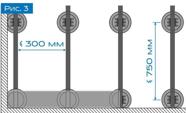
Расстояние между монтажными лагами при диагональной укладке лаг должны уменьшаться в соответствии с углом укладки:
