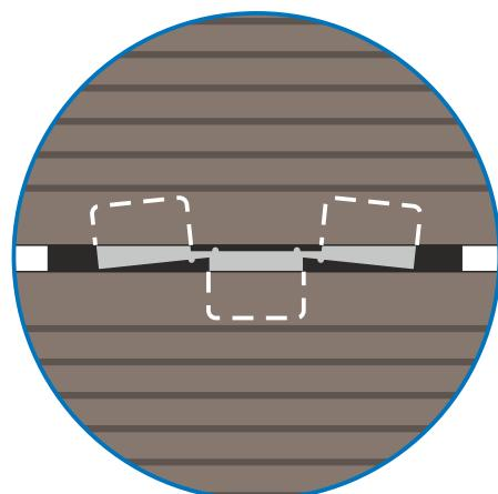
Согнутые «крылья» кляймера дают необходимый продольный зазор между досками для компенсации температурных деформаций.
