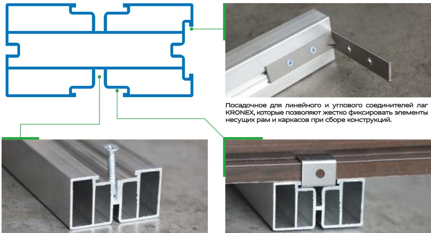
Лаги KRONEX имеют улучшенную направленную систему фиксации саморезов, что значительно упрощает крепление кляймеров и обеспечивает надежную фиксацию.
