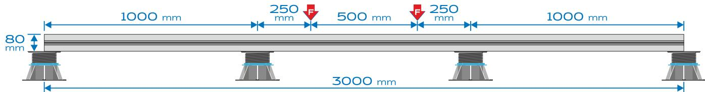
Результат: при нагрузке 1 570,34 кг - разрушение опоры, местные деформации профиля в месте приложения силы (без разрушения самой лаги).
