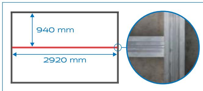
**3** Выставляем среднюю конструктивную лагу 2920 мм и соединяем с помощью угловых соединителей KRONEK и оцинкованных саморезов со сверлом по металлу.
