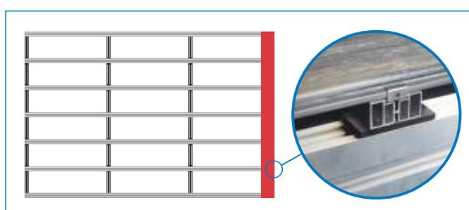
**7** На смонтированную конструкцию начать монтировать террасную доску ДПК Outdoor с помощью стартовых кляймеров для алюминиевых лаг KRONEK.
