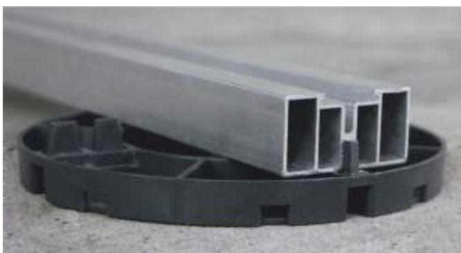
Конструкция алюминиевых лаг KRONEX разработана таким образом, что при укладке на нерегулируемые опоры KRONEX лага одевается на встроенные в опору табуляторы для плитки и тем самым исключает риск смещения, плюс делает процесс монтажа значительно удобнее.
