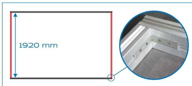
**2** Две лаги длиной 1920 мм выставить как на рисунке и соединить с помощью угловых соединителей KRONEK и оцинкованных саморезов со сверлом по металлу.
