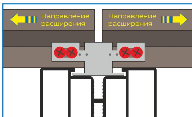
**Фиксация торцевого зазора на стыке двух продольно уложенных террасных досок.**
