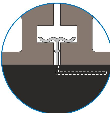
Форма изгиба прижимного элемента позволяет надёжно фиксировать профиль доски с высотой полки 7мм/9мм (на 0,4мм поджим).
