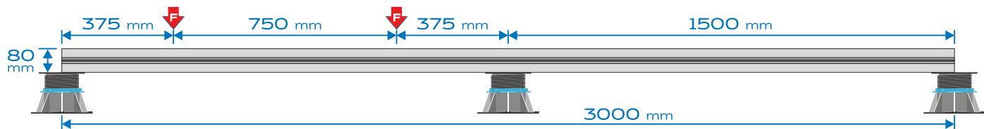
Результат: при нагрузке 1 713,10 кг - разрушение опоры, местные деформации профиля в месте приложения силы (без разрушения самой лаги).
