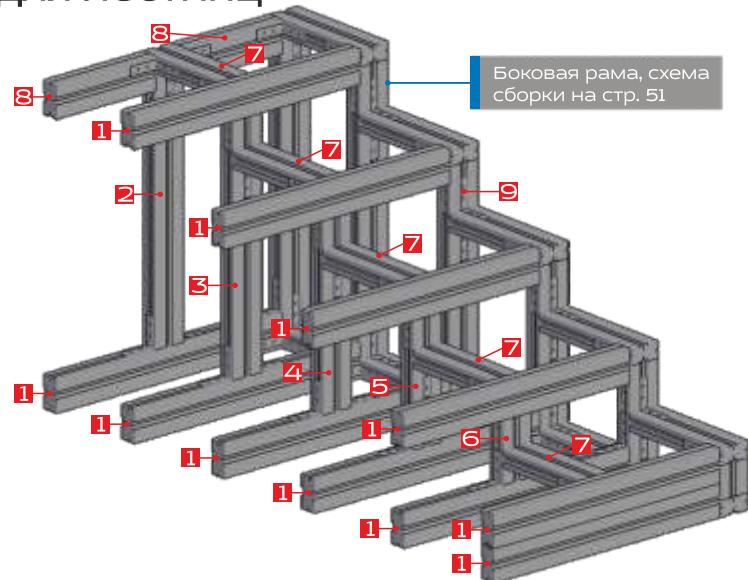
1. Произвести разметку и подрезку лаги алюминиевой KRONEKX 80x40x3000мм конструктивной на отрезки (детали), согласно перечня выше.
