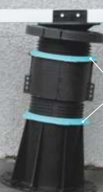
Начиная с опоры KRN-TA3 и выше, а также при использовании увеличителей высоты, применение фиксирующих колец обязательно на каждой винтовой паре – для недопущения самопроизвольного скручивания опоры.
