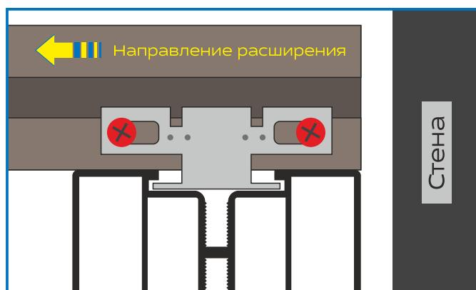
**Сохранение фиксированного зазора у примыкания настила к стене.**
